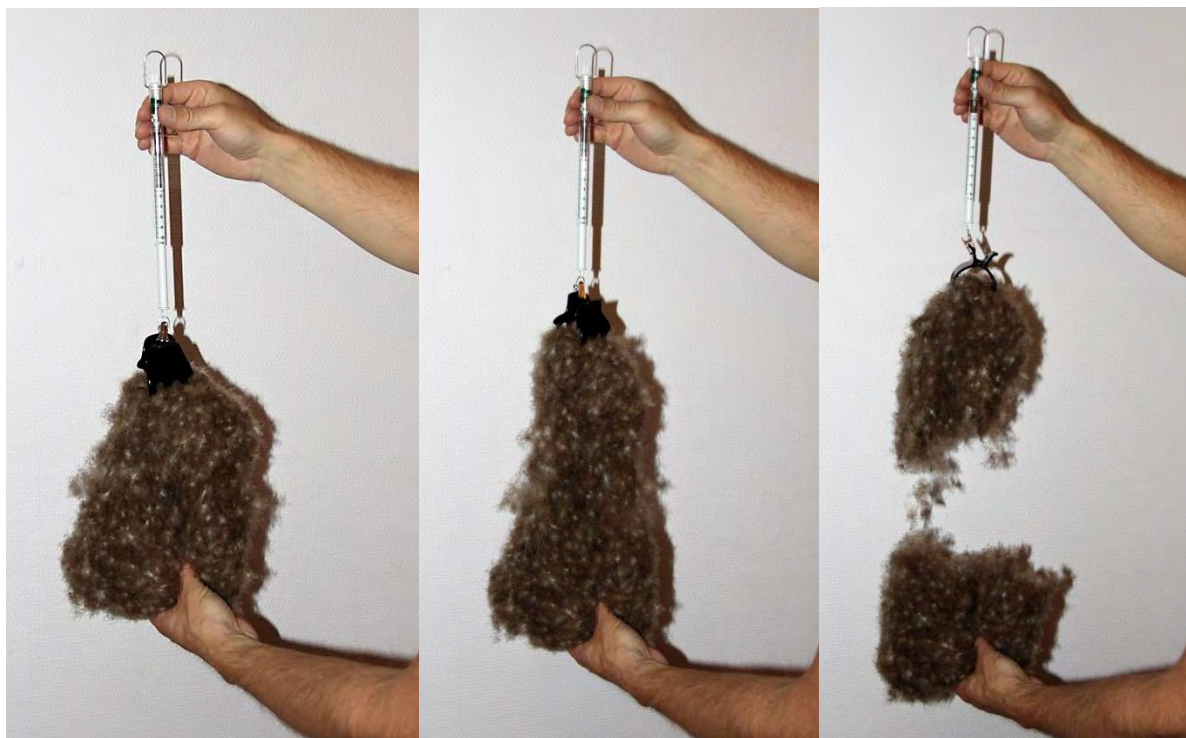
Bilde 25: Bildeserie som viser hvordan strekktesten ble foretatt. 10 gram dun er festet til en hårklype (13,8 gram) som er festet til en fjærvekt. Maksimal kraft avleses på det første bildet (t.v.) før dundotten begynner å dele seg i to (midterste bilde). På bildet til høyre har sammenhengskraften blitt brutt.
